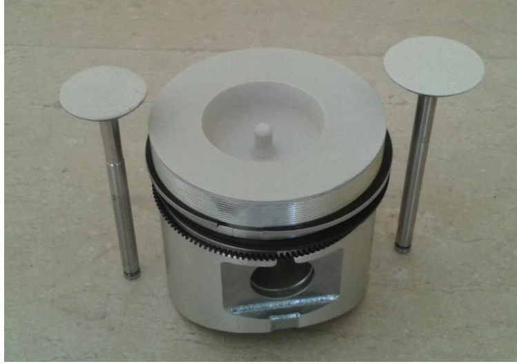
Őekil 2. Piston ve supapların alın yüzeyleri kaplandıktan sonraki görünümü
