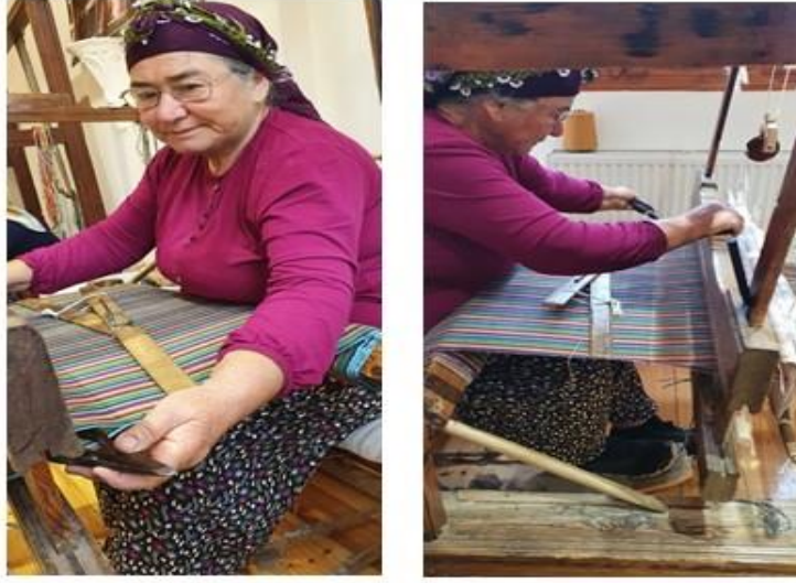
Grsel 13: Dokuma alıřması detay grnt mekiđin atılması ve tarakla tefe iřlemi Usta đretici řerife Aydın (Fotođraf, Tm Cebeci 2022)
