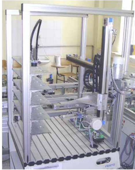
Şekil 8 FMS Otomatik Depolama ve Geri Verme Hücresi.
