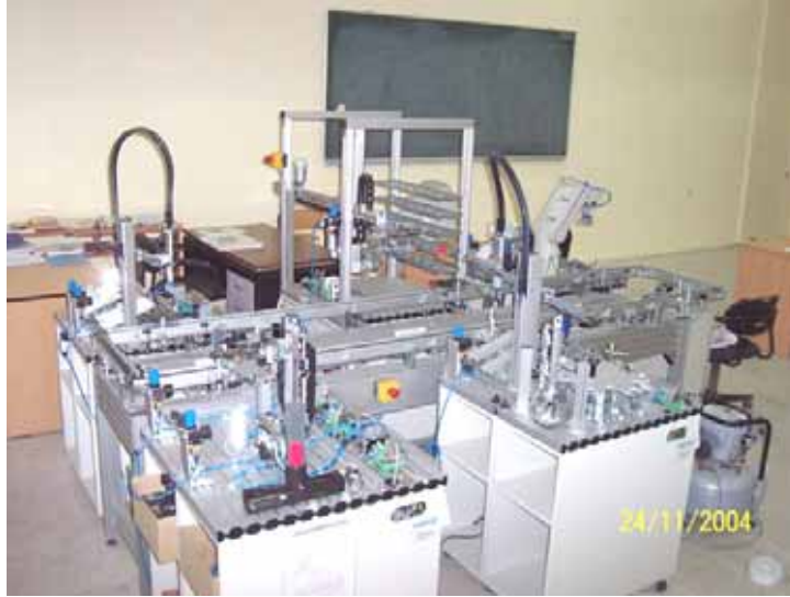
Şekil 4 Eğitim Amaçlı Kullanılan Esnek Üretim Sistemi Görünümü.
