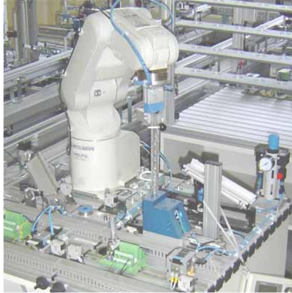
Şekil 7 FMS Robot Birleştirme - Montaj Hücresi.
