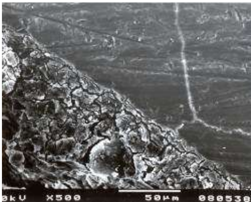
Resim 10. Air abrazyon + poli akrilik asit uygulanan grupta Fuji Triage - mine ara yüzünün SEM görüntüsü (x75 ve x500).
