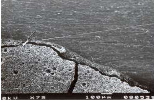
Resim 9. Poli akrilik asit uygulanan grupta Fuji Triage - mine ara yüzünün SEM görüntüsü (x75 ve x500).
