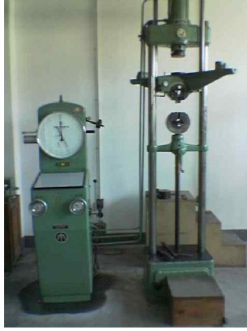
Şekil 4. Pelet mukavemet değeri ölçen Mohr Bfederhoff AG marka üniversal tip hidrolik çekme makinesi
