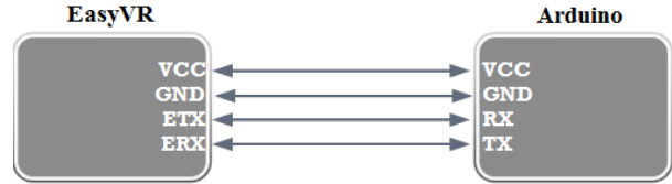
Şekil 3. EasyVR konuşma tanıma modülü - Arduino Uno bağlantısı (Connection between EasyVR speech recognition module and Arduino Uno)
